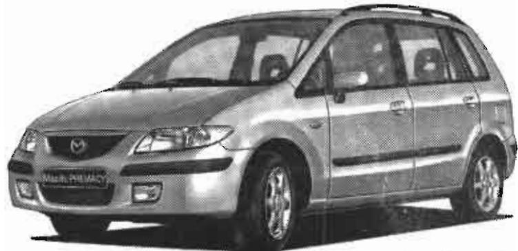
Modell/Ausstattung: 1,9 l, 74 kW (100 PS), D3, ABS, 4 Airbag, Servo-Lenkung, Traktions-Kontroll-System, elektr. Fensterheber + Außenspiegel, Nebelscheinwerfer, Klimaanlage, 15 Zoll Alu-Räder, Audio-System-Touring-Computer
